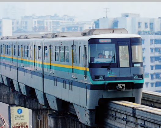
中国首列跨座单轨列车 China's First Straddle Monorail Train
