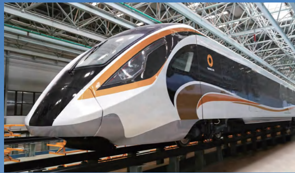
时速160公里全自动市域A型列车 160km/h Full-Automatic Regional Type A Vehicle
